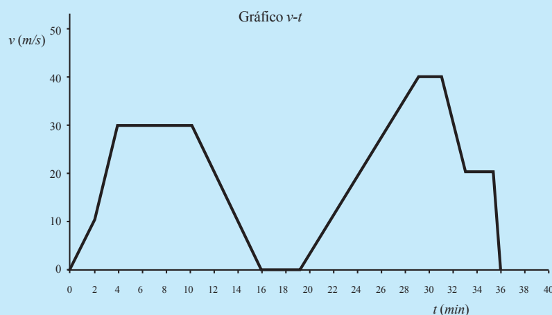
Figura 5.2 – Gráfico da velocidade em função do tempo para o automóvel da atividade 5.6.
