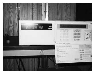
Figura 1.3 – Relógio atômico de césio instalado no ON.
