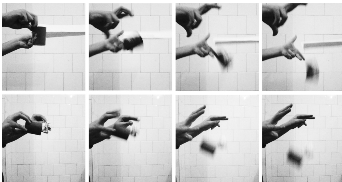
Figura 1.1 – Tempo de queda dos corpos. Acima, um pequeno objeto e uma folha de papel (sem dobrar, na horizontal, e segura por uma de suas extremidades) são soltos ao mesmo tempo por Hugo. Abaixo, a situação se repete, mas a folha agora foi amassada na forma de uma bola. A sequência de fotos tem um intervalo de 0,03s entre cada exposição. Pelas ideias de Galileu, em uma região onde a resistência do ar fosse desprezível, a folha (aberta ou amassada) e o objeto chegariam ao chão no mesmo instante de tempo.
