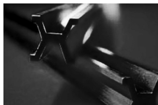
Figura 1.4 – Barra de platina e irídio, à qual foi atribuído um comprimento de 1 m , igual a 10^7 m , a distância entre o Polo Norte e a Linha do Equador.
