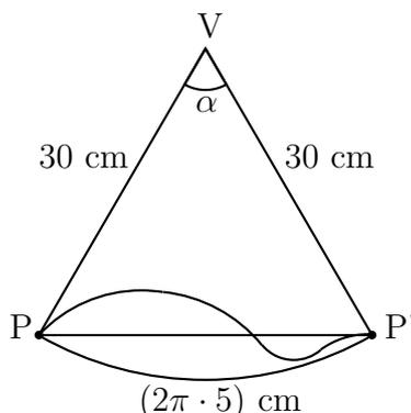
A figura acima é um setor circular. Seu raio tem comprimento igual ao da geratriz, ou seja, 30 cm. O seu arco  $PVP'$  tem comprimento igual ao da circunferência da base do cone original. Como o raio da base do cone mede 5 cm, concluímos que  $PVP' = (2\pi \cdot 5) = 10\pi$  cm. Sendo assim, o ângulo  $\alpha$  é dado por  $\frac{10\pi}{30} = \frac{\pi}{3} = 60^\circ$ .
